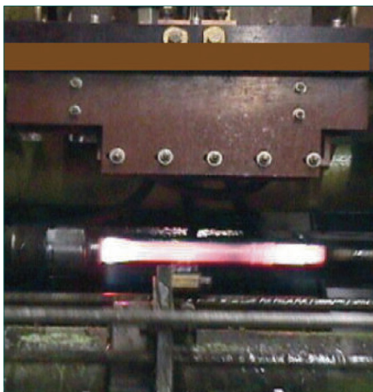
Figure 5. Mise en évidence d'un chauffage hétérogène lié à la conception d'un inducteur.
