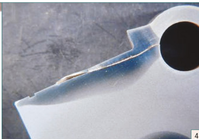
Figure 4 : Tapure de trempe amorcée dans un trou à proximité de la zone trempée mise en extension et se propageant vers la couche durcie. © ECAM
