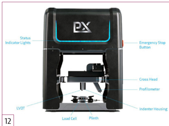
Figure 12: Indenteur PLX-Benchtop réalisant l'indentation et la mesure du profil de l'empreinte pour la méthode PIP.
