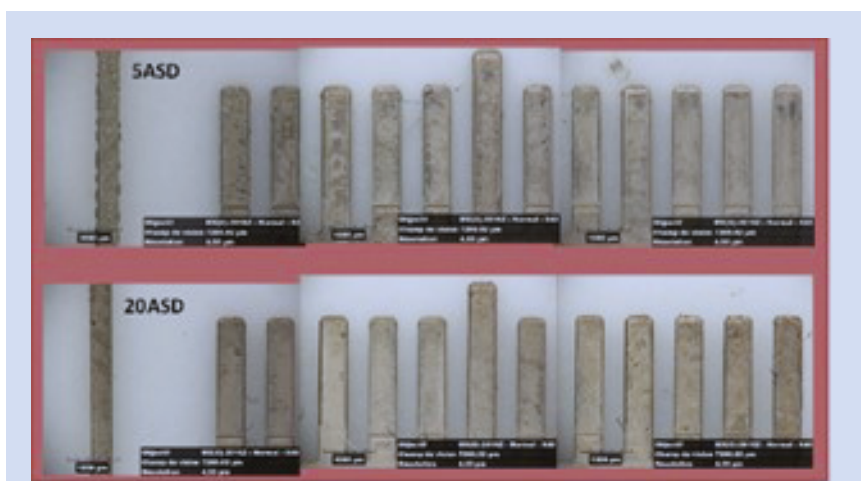
Figure 15 : Photos des échantillons après les tests NAV à 5 et 20ASD pour le nickel sans acide borique
