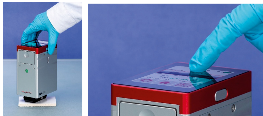
Figure 8 : mesure des angles de contact et de l'énergie de surface en un clic.
