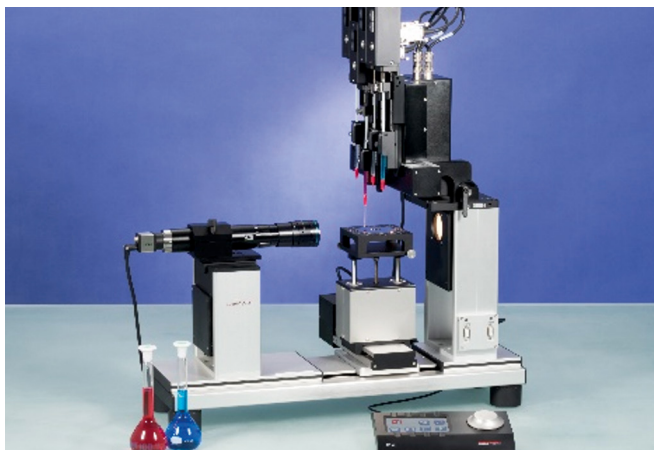
Figure 1a : Dispositif de mesure de l'angle de contact optique OCA 200
