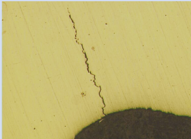
Figure 5 : Fissuration en fatigue par flexion au pied de dent d'un engrenage.
