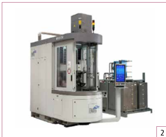
Figure 2. Plateforme Induction Eldec® pour le traitement bi-fréquence simultanée, à l'IRT M2P de Metz
