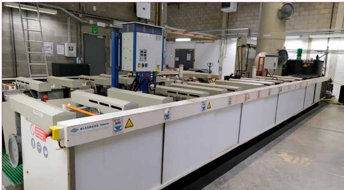
Figure 5. Lignepilote de galvanoplastie utilisée dans le cadre du projet ACHEVALD
