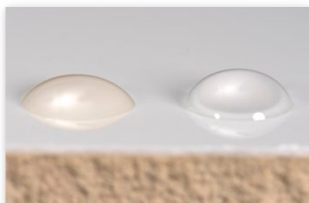
Les angles de contact de deux liquides testés servent de base au calcul de l'énergie de surface de la surface solide.
