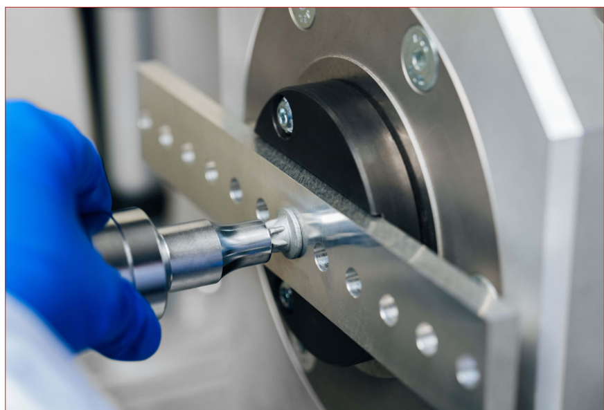
Photo 4 : Essai de serrage contre l'aluminium selon la spécification Mercedes-Benz (MBN 50544).
