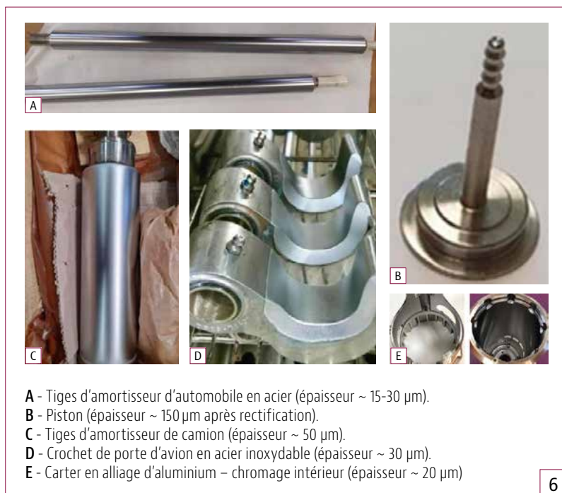
Figure 6. Illustration de pièces chromées avec le procédé DURATRI 240.
