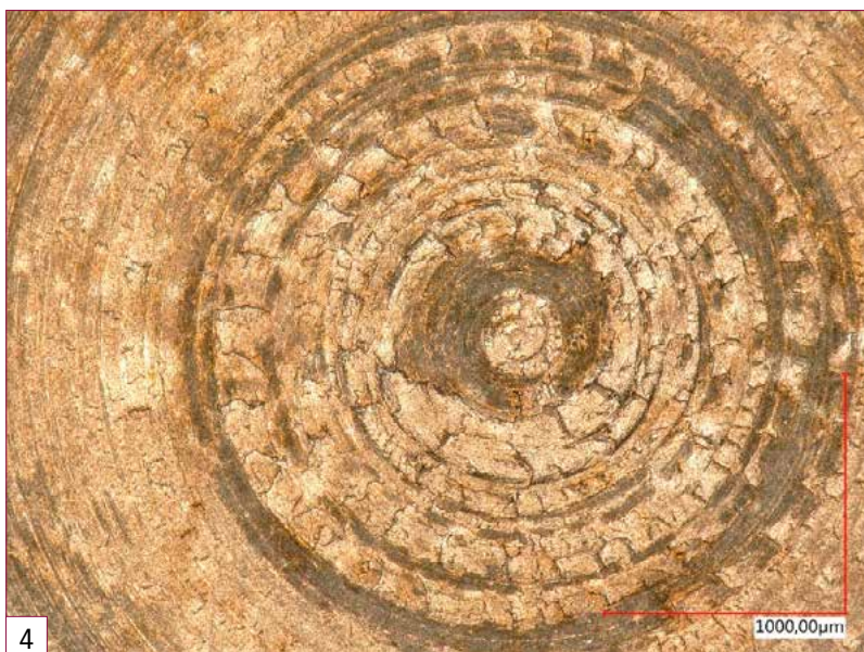
Figure 4. Chrome III électrolytique à ligands organiques après essai en eau à 290°C.
