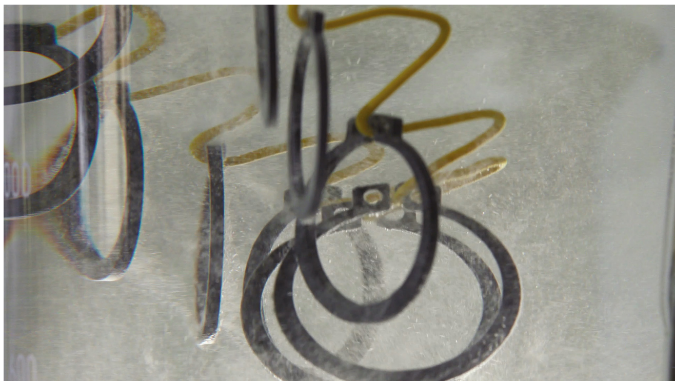
Le marché des pièces de fixation exige de plus en plus de matériaux à haute résistance. Lors de la galvanoplastie, une attention particulière doit être accordée à la fragilisation par l'hydrogène. En photo : échantillon de test de l'anneau en C.
