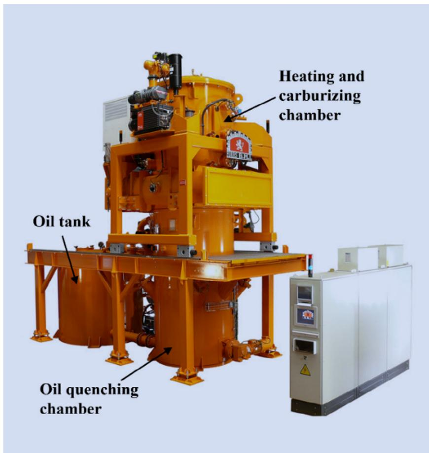
Figure 2 : Four vertical de trempe à l'huile sous vide de la famille V6\_THC de BMI
