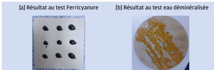
Figure 1. Test au ferricyanure de potassium [a] et à l'eau déminéralisée [b] sur une éprouvette décapée par projection d'abrasif à base de grenaille en acier carbone
