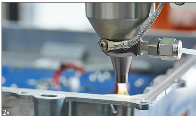
Figure 2 : A. Avant l'application du revêtement, la surface d'étanchéité est nettoyée avec précision par plasma à l'air libre, éliminant efficacement la poussière et les saletés issues des procédés précédents. B. Grâce à différents outils d'analyse, ici le F-Scanner de l'institut Fraunhofer IPM, les contaminants présents sur les surfaces métalliques sont visualisés, permettant ainsi de vérifier l'efficacité du nettoyage au plasma. ©Plasmatrete GmbH
