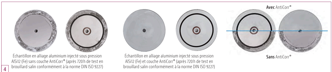
Figure 4. Échantillons d'essai en aluminium moulé sous pression avec l'alliage AlSi12 (Fe) avec et sans revêtement AntiCorr® (après 720 heures d'essai au brouillard salin selon DIN ISO 9227).
