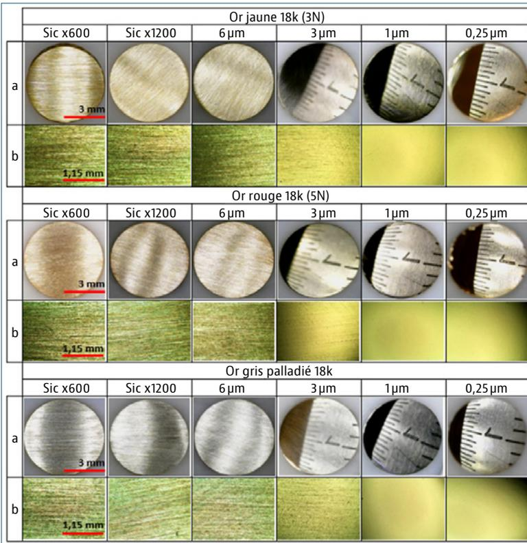
**Figure 5.** Aspect des surfaces des alliages d'or jaune 18k 3N, or rouge 18k 5N et d'or gris palladié 18k après les différentes étapes du polissage mécanique. a) Image obtenue avec la caméra numérique et b) Image obtenue avec le microscope optique (grossissement x5).
