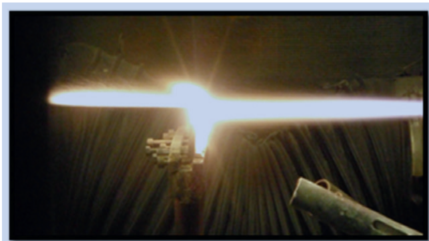
FIGURE 8. Projection HVOF des couches fonctionnelles de NiCr-Cr 3 C 2
