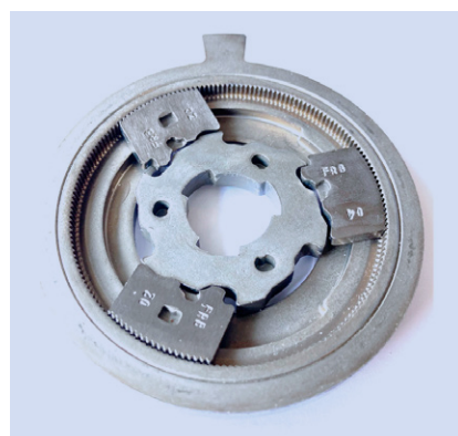
Figure 1 : Pièces typiques d'un mécanisme de dossier de siège nécessitant un traitement thermique. Diamètre extérieur : ~ 80 mm
